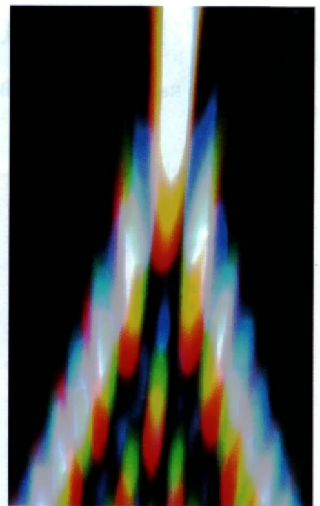
Abb. 6: Farben der Spitzen-Beugungskatastrophe, aufgenommen mit dem Versuchsaufbau der Abb. 4.
